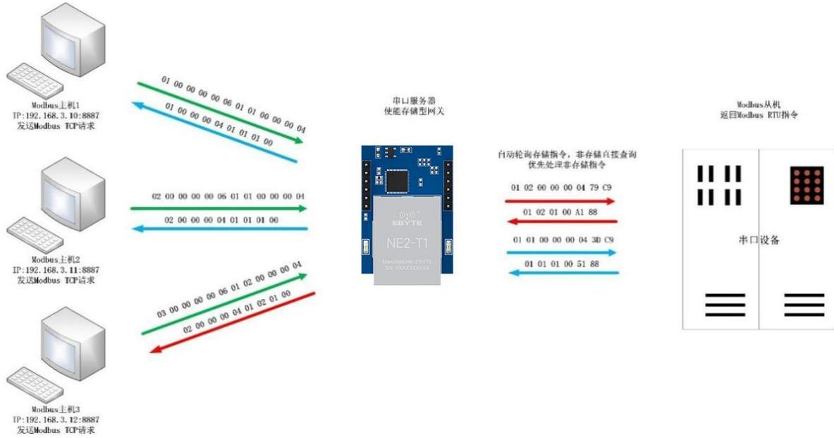
【注】此处以二路主机为例实际使用时最多可以连接6路主机
