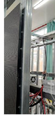
模块接线后磁吸在钢架上
