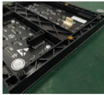
将磁柱安装在模块上
